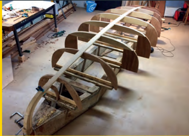
spanten en wrangen op de bouw balk
