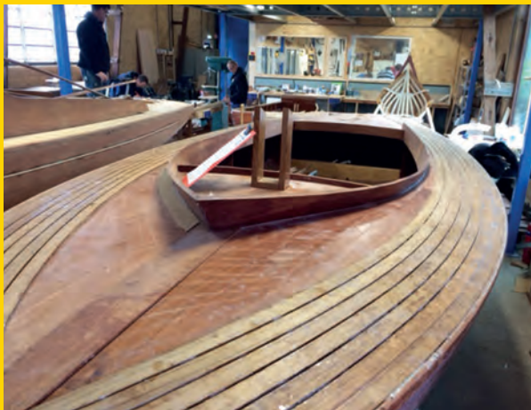
naden vullen met rubber (kit)
