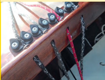
Geen uitsteeksels binnen de kuiprand waar je je rug aan bezeert
