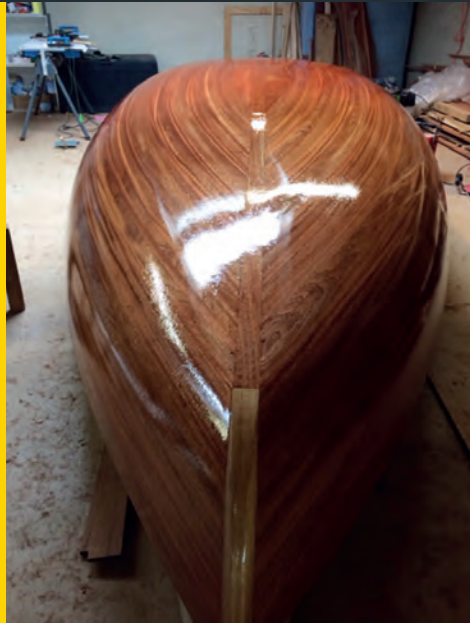
in de eerste laklaag, epoxy
