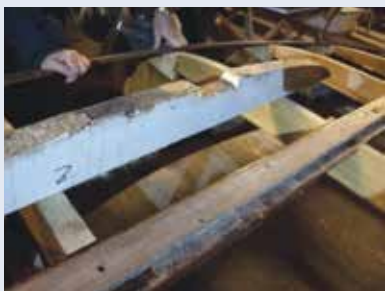
Oude wit geverfde wrang rust uit op fijn-nervig nieuw eiken.
